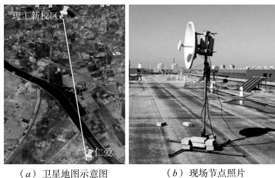
图1 实验床中的20公里长距离无线链路
